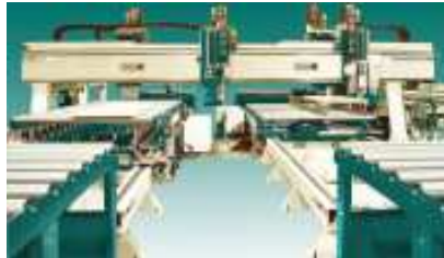
Türenbearbeitungszentrum APF.../...F mit festem Portal, 2 Tischen und 5 Bearbeitungsaggregaten
