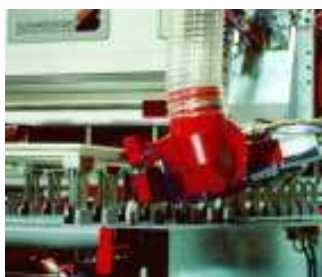
Aggregat an einer Schwenkachse bei der Türenbearbeitung
