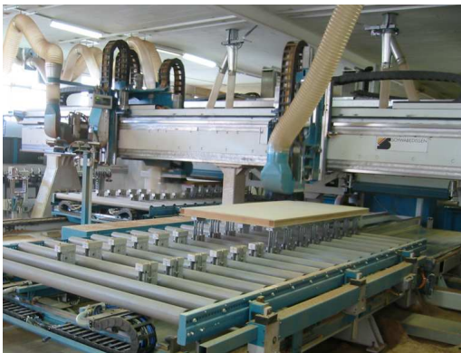
Bearbeitungszentrum APF mit 4 Fräsaggregaten, 2 Stck 120fach Werkzeugwechsler, selbstrüstenden Bearbeitungstischen
